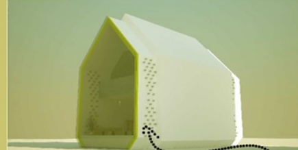
Lietaus vandeni surinkantys elementai iš kurių vanduo patenka į rezervuarą po pirmo aukšto grindimis. Lietaus vanduo panaudojamas buitiniams reikmėms.
